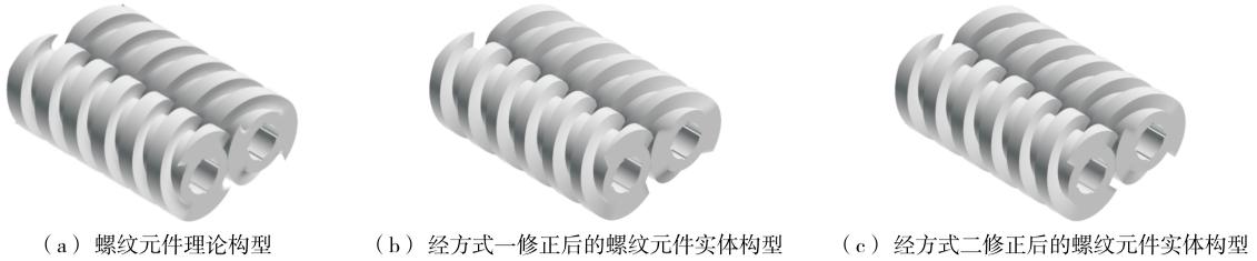
图3 不同构型螺纹元件的几何模型
