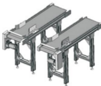
图 6 第二级差速集流输送线
