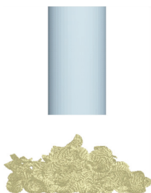
图 3 食用玫瑰花瓣虚拟堆积试验示意图
