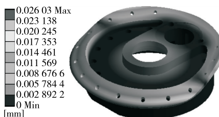
图 12 优化后模型的总位移
