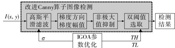
图 2 基于 IGOA-Canny 的鸡蛋裂纹检测过程
