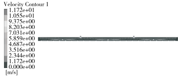
图 5 优化后烘干室 Z=0 m 截面速度云图
