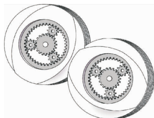
图 2 变速段中行星轮元件 SolidWorks 模型
