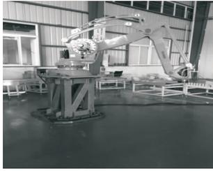
图 1 码垛机器人原型图
