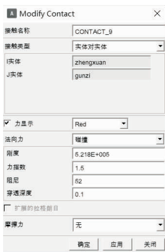
图 3 ADAMS 中 Impact 接触力设定
