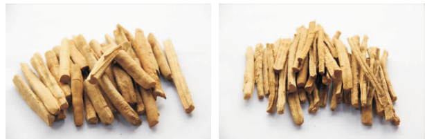
蒸汽—微波协同膨胀处理烟梗 滚筒微波膨胀处理烟梗 图 9 2 种膨胀方式膨胀后烟梗外观对比
