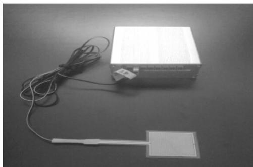
图2 数据采集装置实物图
