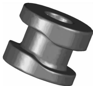
图3 点云处理后的封装曲面 Figure 3 The package surface
