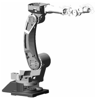
图 1 六自由度关节型食品分拣机器人虚拟样机模型
