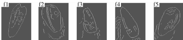
图 6 传统的 Canny 边缘检测效果图
