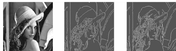
(a) Lena 原图 (b) 传统 Canny 算法 (c) 本研究 Canny 算法
