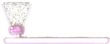
图 7 均料器工作原理示意图
