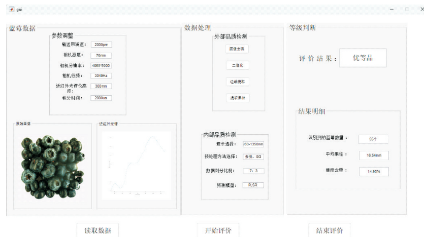
图6 蓝莓在线品质评价系统软件输出主界面
