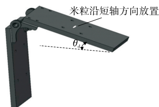
图 2 滚动摩擦系数测量原理
