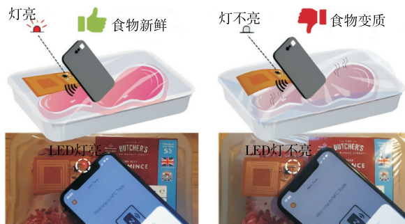
图6 附在食品包装上的NFC应变传感器标签用于肉类产品的变质检测
