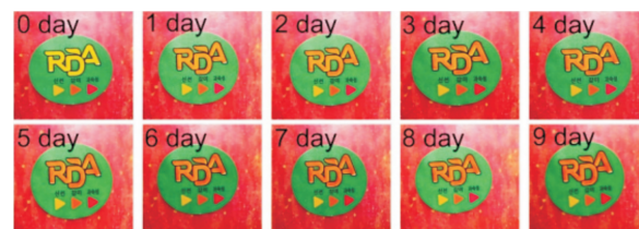
图1 不同成熟度苹果上的传感器标签颜色变化 [28]
