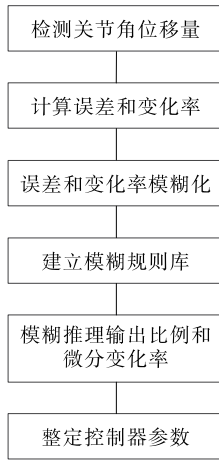
图2 模糊PID控制器参数整定过程
