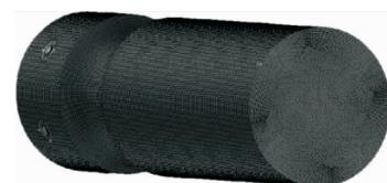
图6 结构化网格划分
