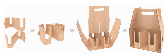
图 19 结构成型步骤(作者自创)
