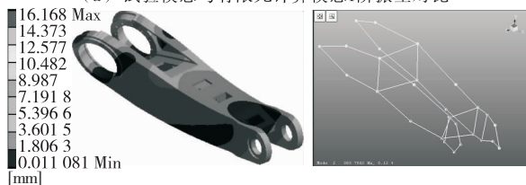
(b) 试验模态与有限元计算模态 2 阶振型对比
