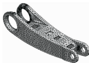
图 3 大臂的有限元模型
