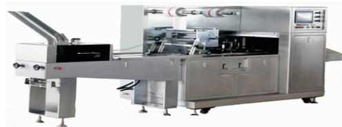
图 8 枕式包装机样机
