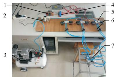
1. 开关电源 2. 气动三联件 3. 空气压缩机 4. 嵌入式控制器
