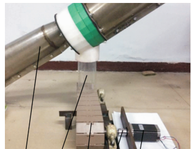
1. 主风道 2. 负压分选管 3. 输送带 4. 联轴器 5. 步进电机 图 7 分选试验台
