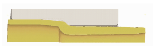
图3 温挤压间隙充不满
