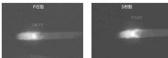
图 3 掺配不同梗丝形态卷烟燃烧温度对比
