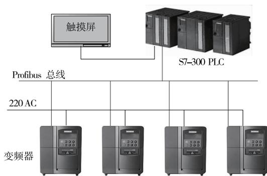
图2 系统网络连接图
