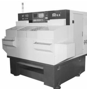
图2 三轴车铣复合加工中心
