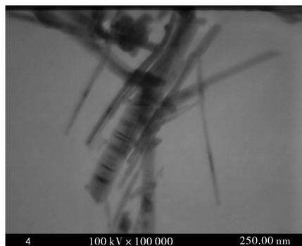
图 1  $\text{Fe}_3\text{O}_4$  纳米粒子电镜图
