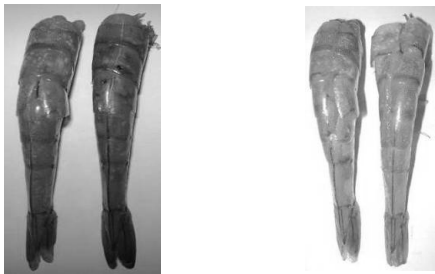
(a) 低转速虾体切割效果 (b) 高转速虾体切割效果
