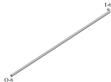
图 9 U 型管出口部分示意图
